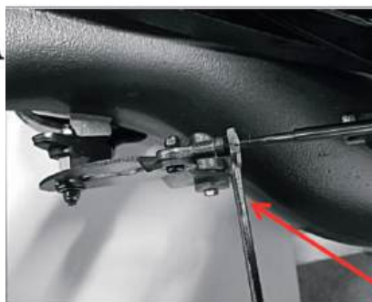
С - ИСПОЛЬЗУЙТЕ ГАЕЧНЫЙ КЛЮЧ, ЧТОБЫ ЗАТЯНУТЬ ГАЙКУ
